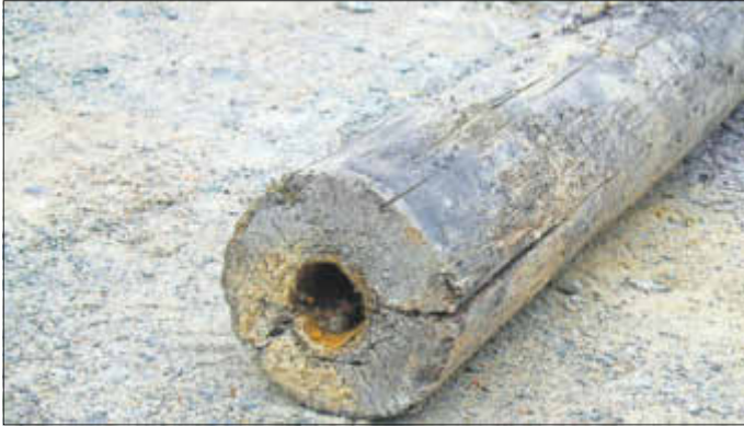
Querschnitt der Holzwasserleitung (Zimmermann)
